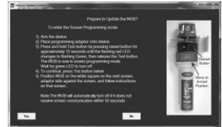
Um den MOB1 in den Programmierungs-Modus zu bringen, halten Sie die TEST/OFF-Taste für mindestens 15 Sekunden gedrückt. Die LED wird anfangen rot zu blinken, dann durchgehend rot zu leuchten, bevor sie anfängt langsamer rot zu blinken und schließlich grün blinkt. In diesem Moment lassen Sie bitte die Test-Taste los und warten darauf, dass die LED aufhört zu blinken. Der MOB1 ist nun im Programmierungs-Modus.
